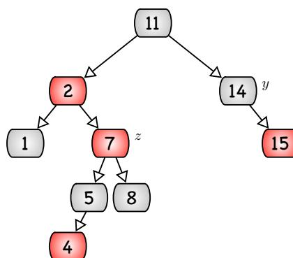
Fall 2:  $z$ 's Onkel ist schwarz und  $z$  ist rechtes Kind seines Vaters.  $z$  wird auf  $p[z]$  gesetzt und eine Linksrotation wird um (das neue)  $z$  gemacht. Dann weiter mit Fall 3. (Der gilt jetzt!)
