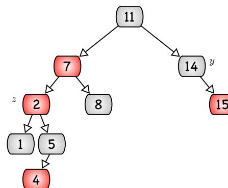
Fall 2:  $z$ 's Onkel ist schwarz und  $z$  ist rechtes Kind seines Vaters.  $z$  wird auf  $p[z]$  gesetzt und eine Linksrotation wird um (das neue)  $z$  gemacht. Dann weiter mit Fall 3. (Der gilt jetzt!)
