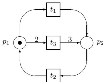
1. Sei  $i$  eine  $S$ -Invariante des Netzes. Gilt dann für alle erreichbaren Markierungen  $m$  die folgende, von  $i$  abgeleitete Invariantengleichung?
