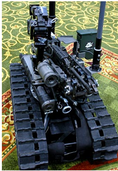
Abbildung 3: Der SWORDS-Kampfroboter mit montierten Maschinengewehr [11]
