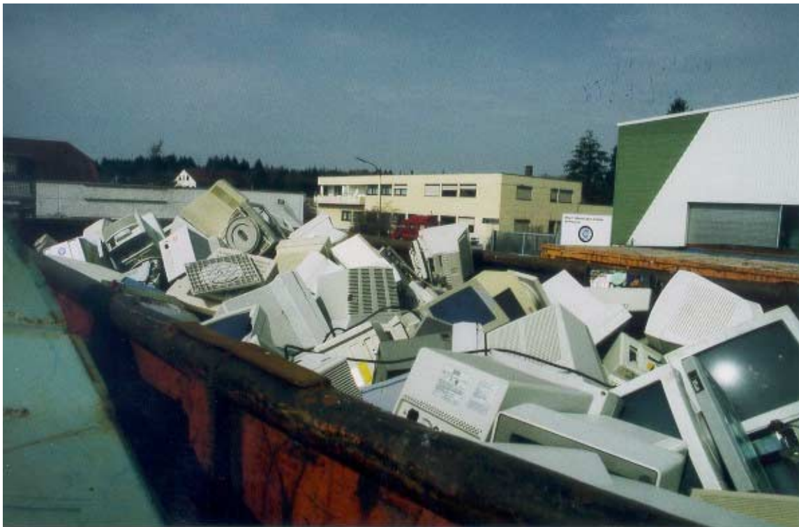
Abbildung 5.1: Unzweckmäßige Sammlung von Monitoren in Großcontainern, hier besteht große Bruchgefahr
