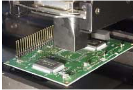
Abbildung 8: Automatische Entstückungsanlage, Fraunhofer IZM, Berlin, September 2000
